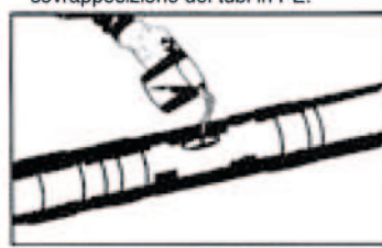
4) Dopo aver atteso il raffreddamento dei manicotti, eseguire l'operazione di colata del poliuretano (poliolo-isocianato), avendo cura diappare successivamente il foro di colata con l'apposito tappo in PE introducendolo solo per metà e, all'arrivo della schiuma al foro, spingere fino in fondo al tappo.
