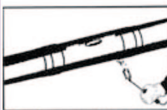
3) Riscaldare con una torcia a gas i manicotti termoretraibili, sfiorando con la fiamma i manicotti stessi in modo costante ed uniforme.
